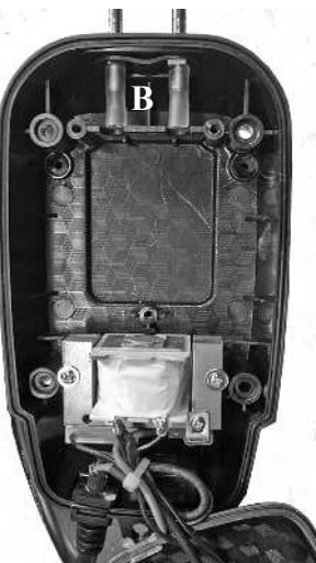
Membrankammeret er fjernet. Be-mærk de 2 små luftslanger (B). Luftkammaren är borttagen. Lägg märke till de två genomskinliga anslutningsslangarna (B).
