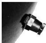
Afløbsskrue in situ / Avloppsskruv på plats
