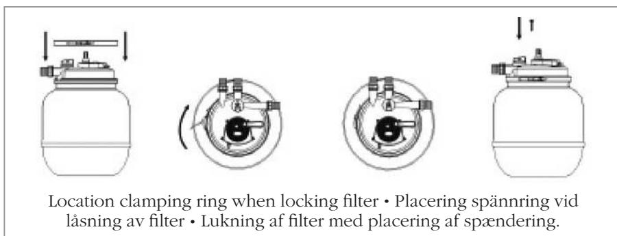
Location clamping ring when locking filter • Placerar spänning vid låsning av filter • Lukning af filter med placering af spændring.
