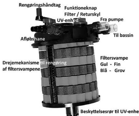
Trykfiltret med indbygget UV-C enhed skal køre kontinuerligt 24 timer i døgnet. UV-C lampen skal udskiftes efter 7000 timer (passer cirka med en sæson), for at sikre at UV-C enheden arbejder med optimal effektivitet.
