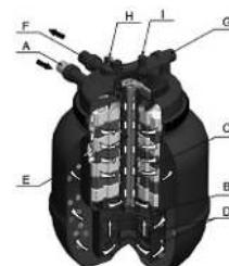
I Bioclear XL 80000 pumpas vattnet från dammen in i filtret via inlopps-adapttern (A) och pressas i en virvelrörelse genom filtersvamparna och ner genom biobollarna. Vattnet fortsätter genom UV-C enheten och lämnar filtret genom utloppssadapttern (F) ut i dammen.
