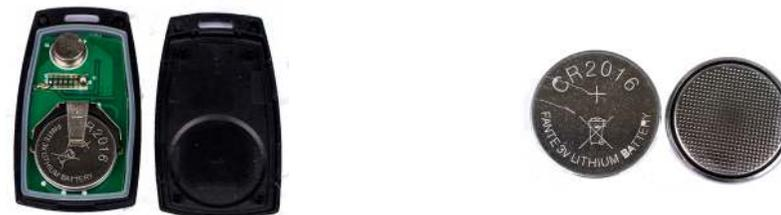
4. Senderen åbnes let uden brug af værktøj, og de gamle batterier kan fjernes. Udskift disse med 2 stk. CR 2016 3V knapbatterier. Monter dem med "tekstsiden" opad, luk senderen sammen igen og monter delene i håndtaget igen. Herefter monteres håndtaget med sender tilbage på teleskopstangen og Pond Clean Techno 9000 er klar til brug.
