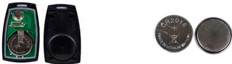
4. Sändaren öppnas lätt utan bruk av verktyg så du kan ta bort de gamla batterierna. Montera de nya med "textsida" uppåt. Stäng sändaren och montera tillbaka delarna i handtaget. Montera tillbaka handtaget med sändaren på teleskophandtagen och Pond Clean Techno är klar att användas.
