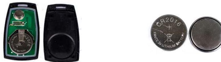
4. Senderen åbnes let uden brug af værktøj, og de gamle batterier kan fjernes. Udskift disse med 2 stk. CR 2016 3V knapbatterier. Monter dem med "tekstsiden" opad, luk senderen sammen igen og monter delene i håndtaget igen. Herefter monteres håndtaget med sender tilbage på teleskopstangen og Pond Clean Techno 9000 er klar til brug.
